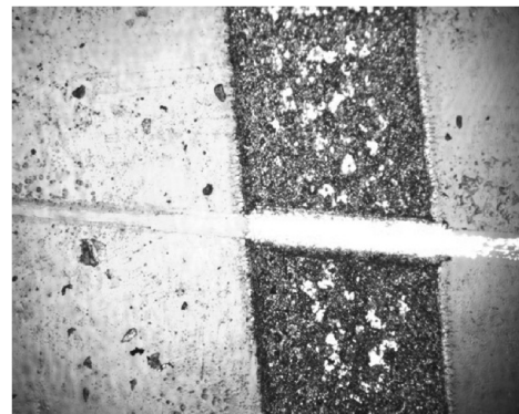
Fig. 6. Typical scratch track line through silver thin films and copper filaments 6. ábra Tipikus karcsom az ezüst vékonyréteg bevonaton a réz fűtőszállal
