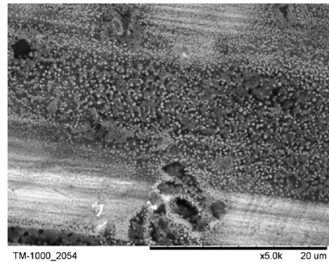
Fig. 4. Typical defects on surface of copper filaments 4. ábra Az üvegfelületre felvitt réz fűtőszálak felületének tipikus hibái
