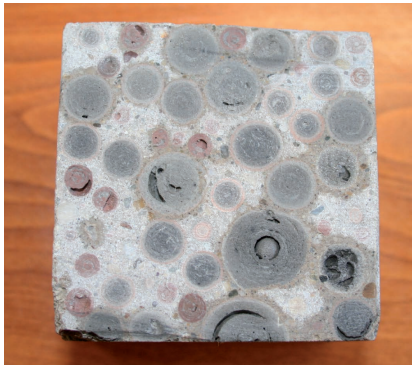
6. ábra Az 1. jelű duzzasztott üveg adalékanyagos próbatest vágott felülete koptatás előtt Fig. 6. Cut surface of the specimen with expanded glass aggregate (specimen no. 1.) before abrasion test
