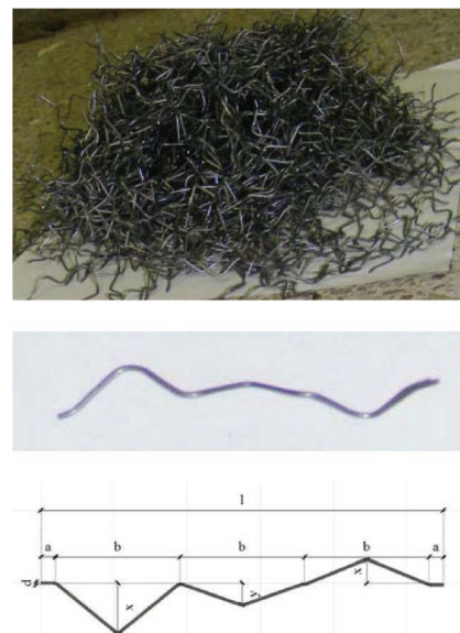
Fig. 5. 3D deformed, twisted steel fibre, PetiX S60 5. ábra Három dimenzióban megmunkált PetiX S60 acélszál
